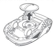
2 Retirer le couvercle de protection du lidar.
