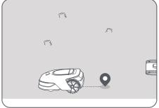
3 Télécommander l'A1 pour se déplacer le long de la bordure de la pelouse pour créer la zone de travail. Lorsque l'A1 est télécommandé pour créer la limite, ne pas oublier de :
