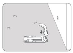
3 Insérer la brosse de nettoyage dans la tour de chargement en alignant la languette sur la rainure.
