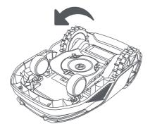
4. Nettoyez le corps, la lame et le châssis de l'A1 avec un tuyau souple.
