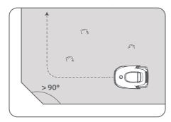
4 Lorsque l'A1 retourne à la place à 1 m à proximité du point de démarrage, vous pouvez taper sur « Fermer la délimitation » et la limite sera automatiquement complétée.
