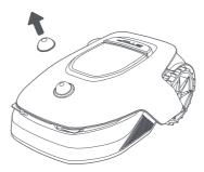
3 Appuyer sur le bouton **Arrêt** pour ouvrir le couvercle du panneau de contrôle. Appuyer sans relâcher sur le panneau de contrôle pendant 2 secondes pour **allumer** l'A1.
