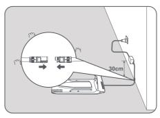
**6** Mettre l'A1 dans la station de chargement pour le charger. Assurez-vous que les contacts de chargement sur l'A1 et la station de chargement sont correctement raccordés.
