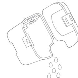
2. Reinigen Sie den Schmutzwassertank mit Wasser und setzen Sie ihn wieder auf die Basis.
